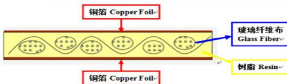
半固化片通常由玻璃纤维布（又称玻纤布）作为增强材料，在玻纤布表面均匀涂布特别调配的树脂后，经上胶烘干后制成，俗称胶片。半固化片的主要作用电路绝缘，并粘结固定铜箔电路。
